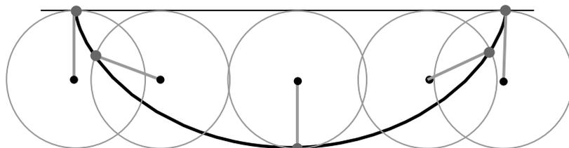
Fig. 14.4. Construction d'une cycloïde
